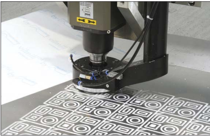
Kleine und filigrane Formen entstehen aus einer Aluminiumplatte.
